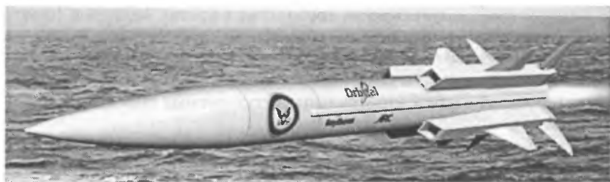
Рис. В. 17. Внешний вид АР с ИРПДТ [В.2]
